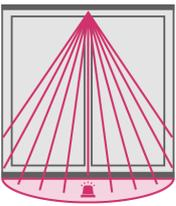
Setzen Sie auf gezielte Abschreckung, die die Optik Ihrer Fenster nicht stört. Unauffällig im Blendrahmen Ihrer Fenstersysteme verbaut, sorgt Smart Guard aktiv für präventive Sicherheit. Der intelligente Erkennungssensor registriert Einbrecher und startet anschließend selbstständig das Abwehrprogramm.
